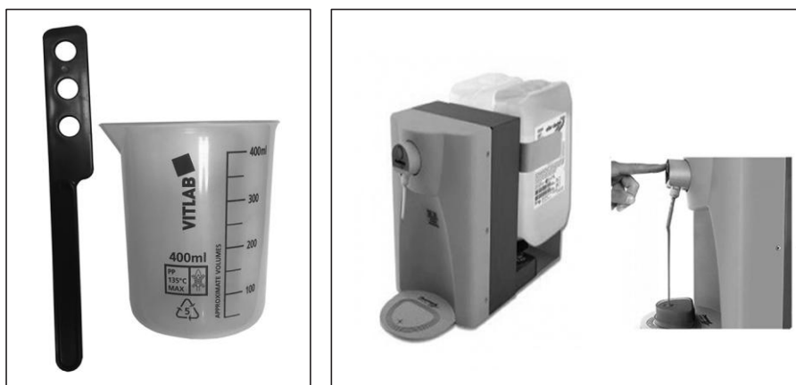
Рис. 4. Емкость и шпатель для ручного смешивания винилполисилоксановых материалов (а) и устройство для автоматического смешивания компонентов винилполисилоксановых дублирующих материалов (б)
